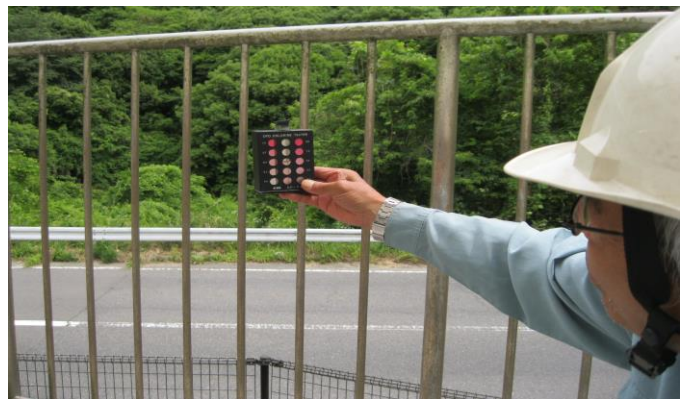
処理水の残留塩素測定研修(濃度測定器)
